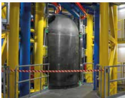
5g wirken bei der Beschleunigung auf die Endgeschwindigkeit von 72 km/h innerhalb von 0,5 s auf die Gondel, die Antriebswagen und das Experiment
